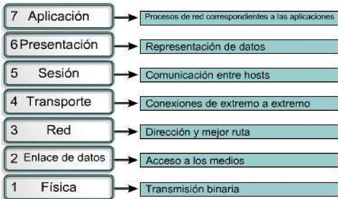
• Cables, conectores, voltajes, velocidades de transmisión de datos
